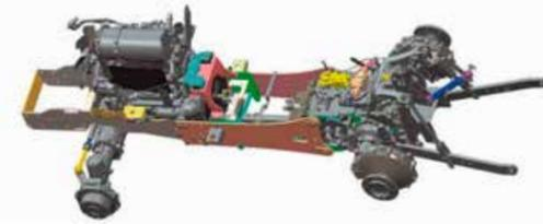
Vibrationsabsorbierende Rahmenstruktur. Die Rahmenstruktur dämpft sowohl Lärm als auch Vibrationen, um dem Bediener ein ideales Arbeitsumfeld bei einem Geräuschpegel von nur 77 dB (z.B. beim Modell 359) zu bieten.
