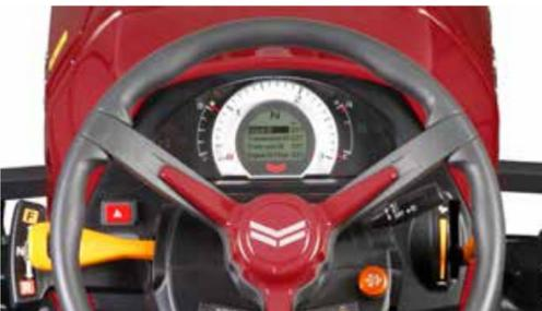
LCD-Display mit elektronischen Steuerungen. Die Instrumentenanzeige erinnert Sie an wesentliche Betriebsfunktionen und Wartungsintervalle.
